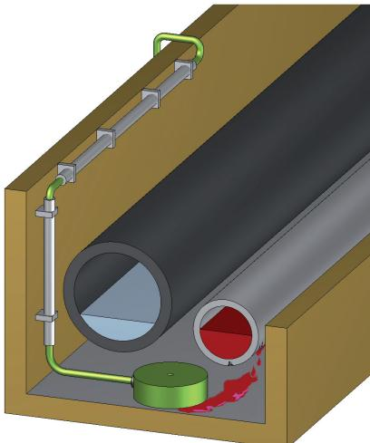
För anslutning till: PLC eller DDC enhet, liten styrenhet, fältbuss nod eller nätverkskontakt med galvanisk separation av sensors kapacitiva elektronik och det överordnadesystemet.
